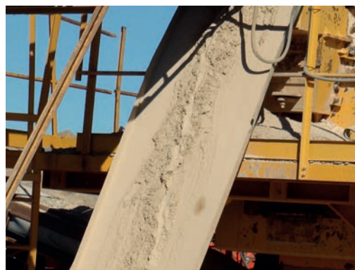
Fig. La capacidad del material para retener la humedad puede ser de la máxima utilidad para evitar la puesta en suspensión de polvo y optimizar la frecuencia de riego y humectación.
