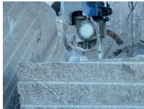
Fig. Captación localizada en la perforadora
