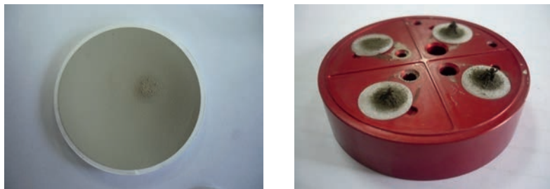
Fig. Substratos y membrana en impactadores tras la toma de muestras que permiten observar el método de clasificación en que se basan.
