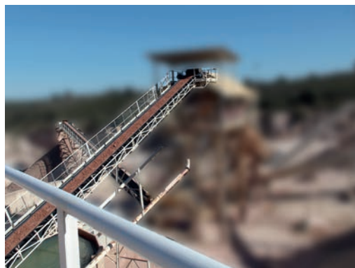
Fig. Material húmedo que no pone polvo en suspensión. En las instalaciones de este tipo, se debe prestar especial atención a los arranques en vacío, y al mantenimiento adecuado ante ausencia de agua, cuando la misma no sea imprescindible para el proceso.
